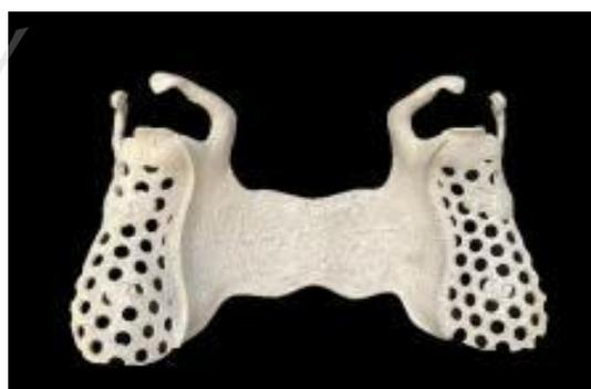
图 (6) 激光选区熔化制作的实体扫描模型
