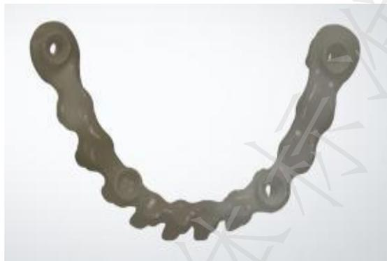
图（10）激光选区熔化制作的实体扫描模型
